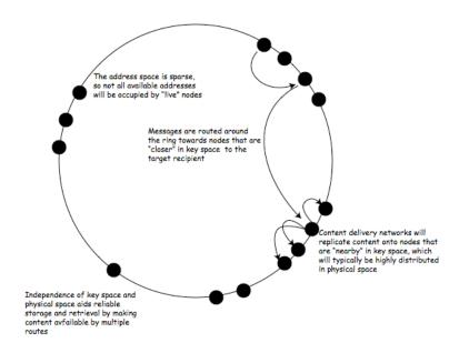
Figure 4 Typical peer-to-peer ring topology for node identifiers Topologie typique d'un anneau P2P pour l'identification nodale
